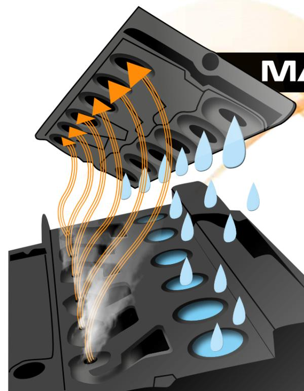
Les batteries FARNHIGH de la gamme auto, grâce à leur couvercle spécifique totalement soudé qui limite la perte en eau et leur technologie 100% calcium, ne nécessitent aucune maintenance.
