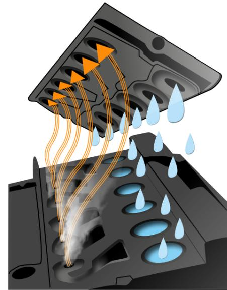
Les batteries Freebatt sont équipées d'un couvercle spécifique totalement soudé qui limite la perte en eau. Ce type de couvercle est conçu pour maintenir l'électrolyte condensé à l'intérieur de la batterie afin d'en limiter la perte. Ce système va collecter les condensats et les rediriger efficacement vers les cellules pour qu'aucun rajout d'eau ne soit nécessaire.
