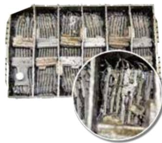
L'une des conséquences de la température élevée est l'expansion de la grille positive (qui peut être également due à l'âge de la batterie, à des charges trop élevées ou des décharges excessives). Celle-ci entraîne une destruction de la grille ainsi que des courts-circuits.
