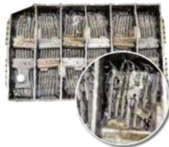
L'une des conséquences de la température élevée est l'expansion de la grille positive (qui peut être également due à l'âge de la batterie, à des charges trop élevées ou des décharges excessives). Celle-ci entraîne une destruction de la grille ainsi que des courts-circuits.
